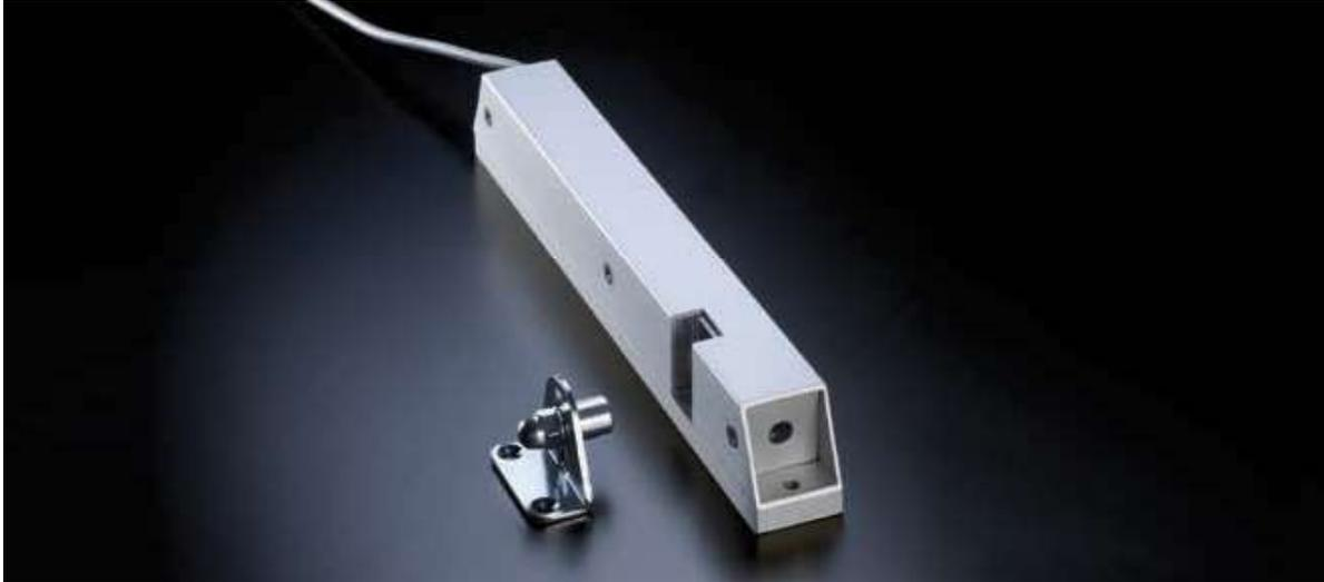
Die elektromotorische Zusatzverriegelung wird in Verbindung mit Linearantrieben an großen Flügeln ohne eigenen Beschlag eingesetzt. Mit ihrer Hilfe erhält man einen zusätzlichen Verriegelungspunkt und stellt bei großen Flügeln einen ausreichenden Dichtschluss sicher. Durch eine zusätzliche mechanische Zweitverriegelung ZWV können so auf einer Flügelseite zwei zusätzliche Verriegelungspunkte erzeugt werden.
