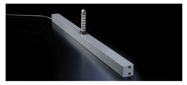
Mit 300 N Zug- und Druckkraft sind die EM-Antriebe die Standardantriebe für Anwendungen im mittleren Leistungsbereich. Durch ihre geringe Aufbautiefe eignen sie sich gut für Anwendungen mit engem Montageraum, z.B. auch vor Beschattungen. Durch ihre geradlinige Formgestaltung passen sie sich optisch unauffällig an Fenster- und Fassadenprofile an. Die Antriebe sind erhältlich als EM/2 oder als EM/EasyDrive/2 mit vielseitigen Einstellmöglichkeiten.
